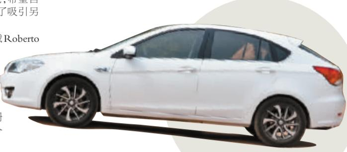
东南V5T/V6T是东南汽车打造的“动力+操控”组合，Turbo车型搭配三菱技术全铝1.5 MIVEC TURBO发动机，它可以在2500r/min时爆发出高达200Nm的扭矩，并且最大功率可达110kW。全新优化的增压技术最大优势就在于其灵敏而迅捷的爆发力，起步加速推背感明显，动力响应迅猛，在转数达到2000转的时候涡轮即介入，低转速换挡亦能保证较高燃油应用效率。1.5T相当于近2.0排量动力。
