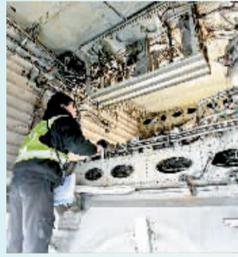
3 每次飞机起飞前，仅一个起落架舱，技术人员就要进行40多个项目的安全检查。
