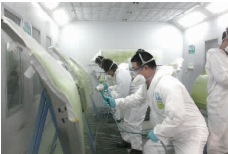
工人们在使用绿色环保材料水性漆施工。（资料图片）
