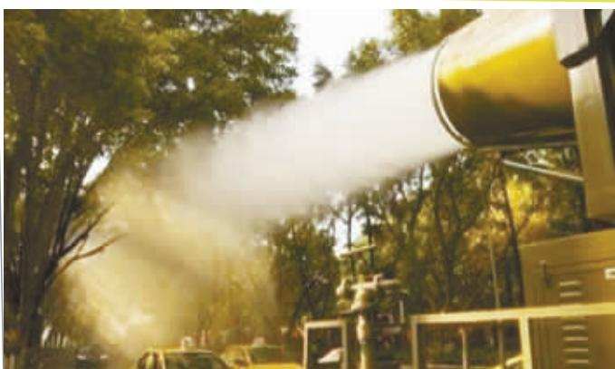
如果最近你在重庆九龙坡区主干道穿行，有可能看到了这台新型洒水抑尘车：军绿色车身，车上面架起一个如大炮一样的东西，向外喷射水雾。据介绍，这车可以360度旋转，射程可达100米。喷洒过后可让空气中80%的扬尘降落到地上。
