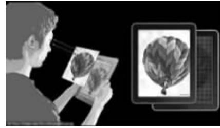
据外媒报道，加州大学伯克利分校的计算机和视觉专家正在探索一项科技，开发计算机运算程序，发明出矫正视力的显示屏，使用户无需戴眼镜或隐形眼镜就可以看清显示屏上的文字和图片。这种显示屏更重要的功能在于，它终将帮助克服更加复杂的视觉问题，比如眼镜无法矫正的高阶像差问题。
