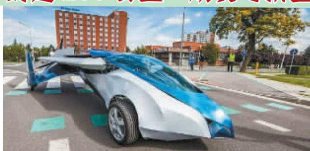
汽车飞上空中避开交通堵塞，这似乎是人们幻想数十年的科幻电影场景。而如今，斯洛伐克一家公司研发的飞行汽车终于要面市了。它的一箱汽油可持续飞行692公里，翅膀折叠后可停入正常停车位。在处于汽车模式时，AeroMobil可使用加油站提供的普通燃料。进入飞行模式时，汽车双翼打开，好像插上了翅膀，时速可达200公里。
