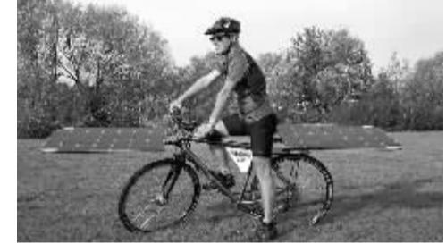
荷兰软件工程师阿诺德·范达伦发明了一款太阳能电动车，直接把太阳能转化为电能，驱动车子前行。车子主体一如普通自行车，只是在车把前和后座上安装了两块0.5米见方的太阳能板，且行且充电。车子最高时速可达22公里。过去3个月间，范达伦骑着太阳能电动车跋涉了1609公里。范达伦将手工打造50辆太阳能电动车，每辆售价12.6万美元。这省力的代价有些高啊。
