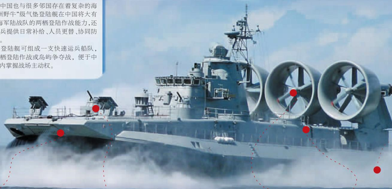
读者或许会担心这“牛”皮会不会被打破,其实这是“野牛”的柔性围裙,作用是保持垫升发动机形成气垫的稳定,使“野牛”能“飞”起来,“牛皮”很结实的,破几个洞不会影响战力的。
