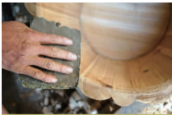
用细沙皮将桶边打磨光滑
