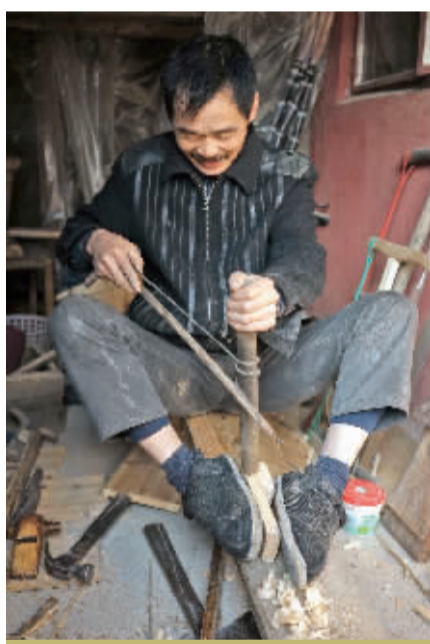
在构件上钻孔
