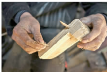
将木签子放入打好的洞中将每块木板榫接起来
