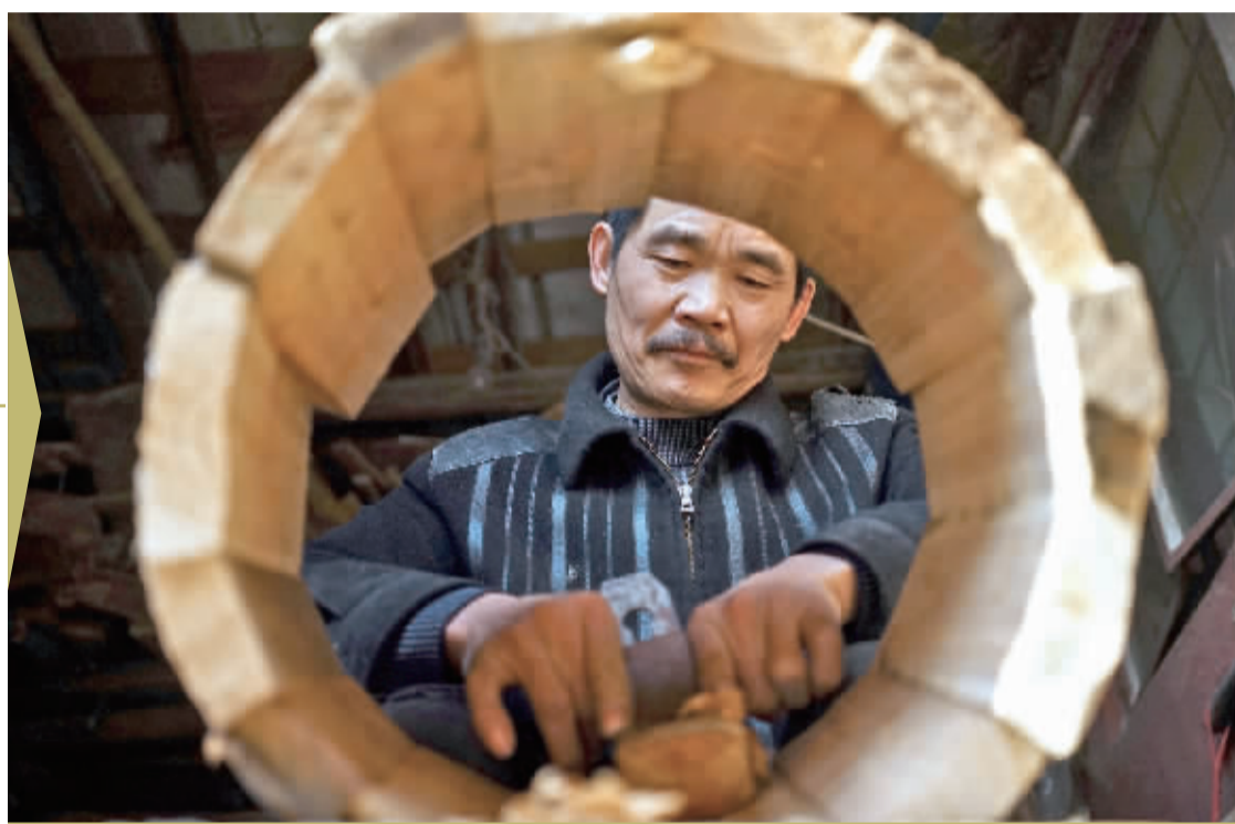
用刨子将木桶内部刨平整
