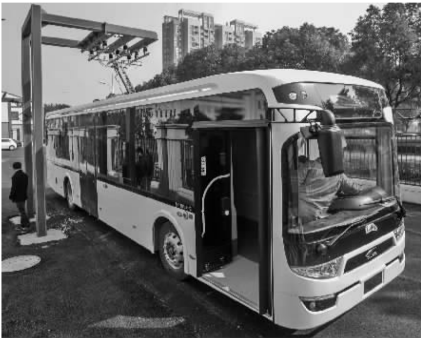
停靠在充电桩旁充电的无轨电车。
