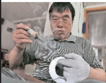
而今，传统的镏器制作也革新了手段，这是黄新国在用电烙铁焊接。
