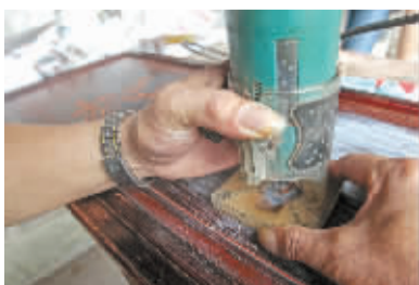
4.根据线条在底板上打凹槽。
