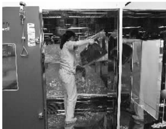
工作人员将待测汽车脚垫放进“袋子法采样舱”。
