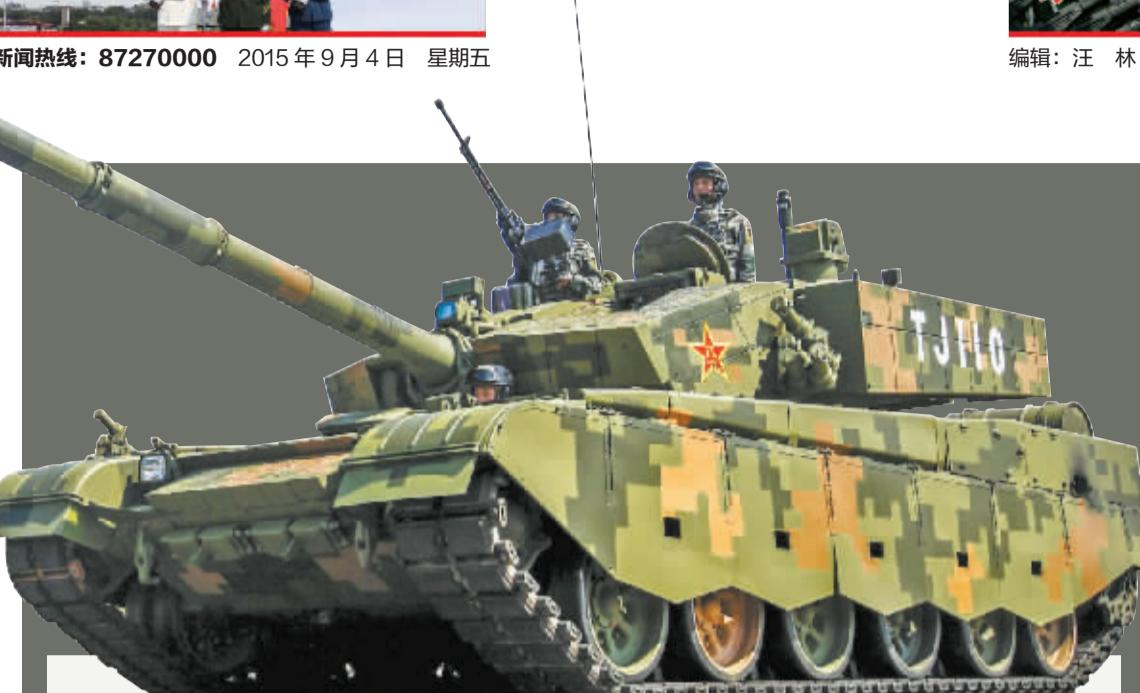
**【动力系统】**采用1500马力系列柴油机，传动装置为液力机械式传动系。
