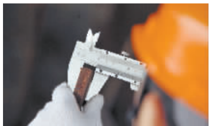
用游标卡尺测零件大小。
