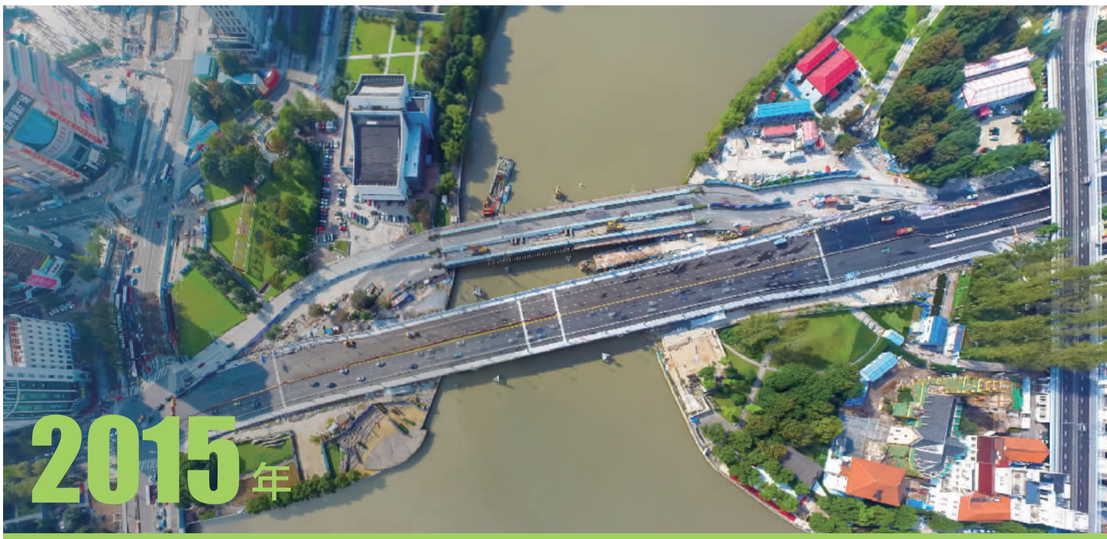
老的新江桥被拆除，西侧建了临时通行的便桥。（资料图片）
