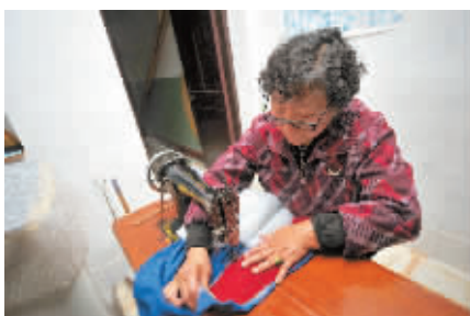
缝合：用缝纫机将鞋帮缝好，缝合的同时填充好棉花。
