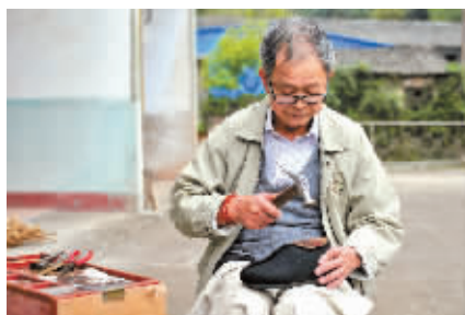
定型：敲打鞋楦，以撑紧鞋帮，达到给鞋子定型的目的。
