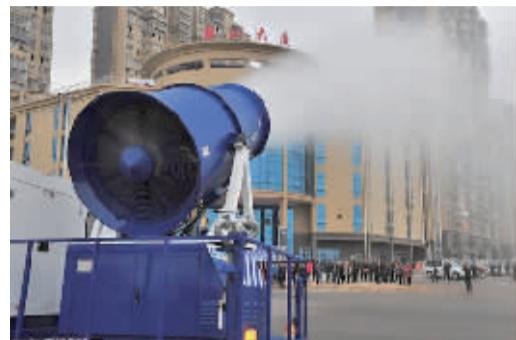
@Archer：[12月8日，长沙市雨花区在湖南率先试用高科技雾炮车上路流动除尘作业，身管长2.3米、口径1.2米的“巨炮”朝天“轰击”，一个半小时内可将9吨水化为超微水雾喷洒一空，有效降尘驱霾。]同学们，这就是今天要学的成语“杯水车薪”，都记住了吗？
