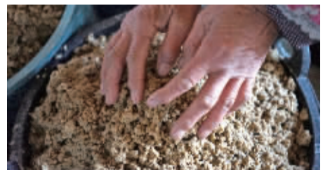
各种原料混在一起,直接制出来的纸是黄色的,如果需要白色的纸,还需再加上漂白工序。
