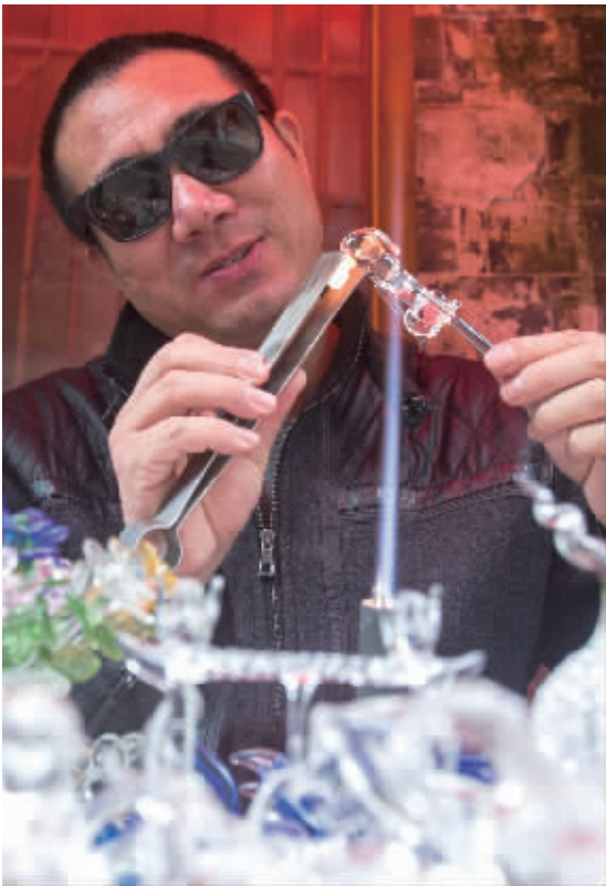
火枪喷出细长的蓝焰，适合雕琢玻璃工艺品的细节。
