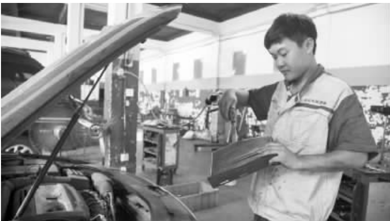
在一家汽车修理厂, 师傅正在清洁空调滤芯。
