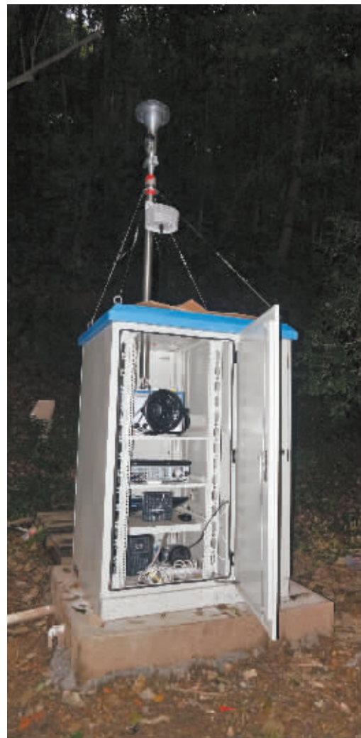
投放在东钱湖的水质在线监测设备。
