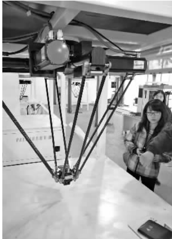
高速并联机器人被广泛应用于食品、医药生产等行业。 记者 陈旭钦 文/摄
