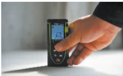
用激光测距仪测量房屋层高。
