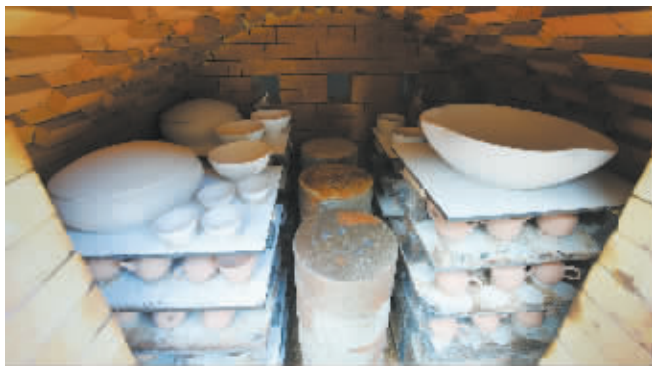
毛坯被直接放置在窑内，柴窑瓷讲究的就是裸露烧制。
