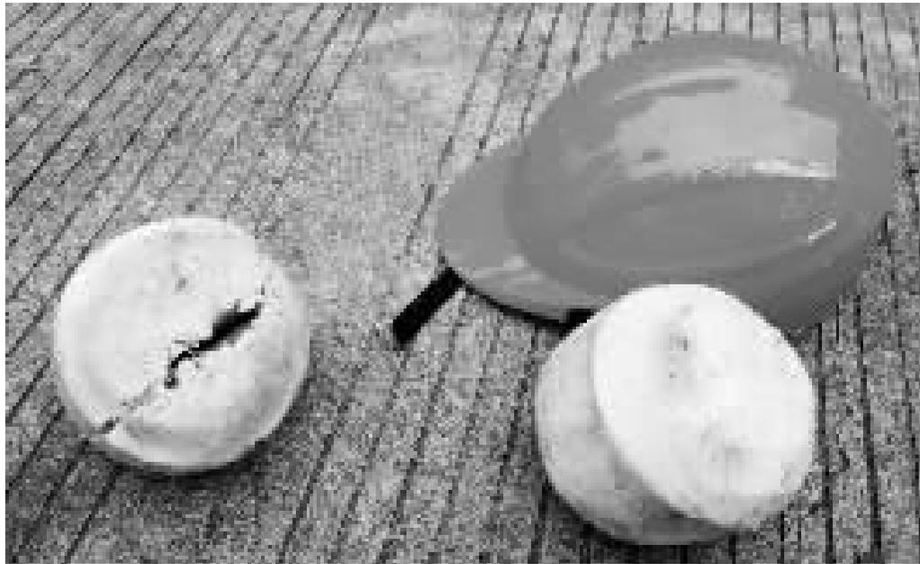
实验中,未套头盔的椰子(左)裂开了口子,套头盔的椰子(右)仅表面擦伤。
