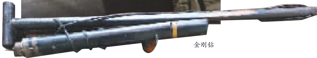
应培明用 金刚钻在瓷器 上钻孔。
