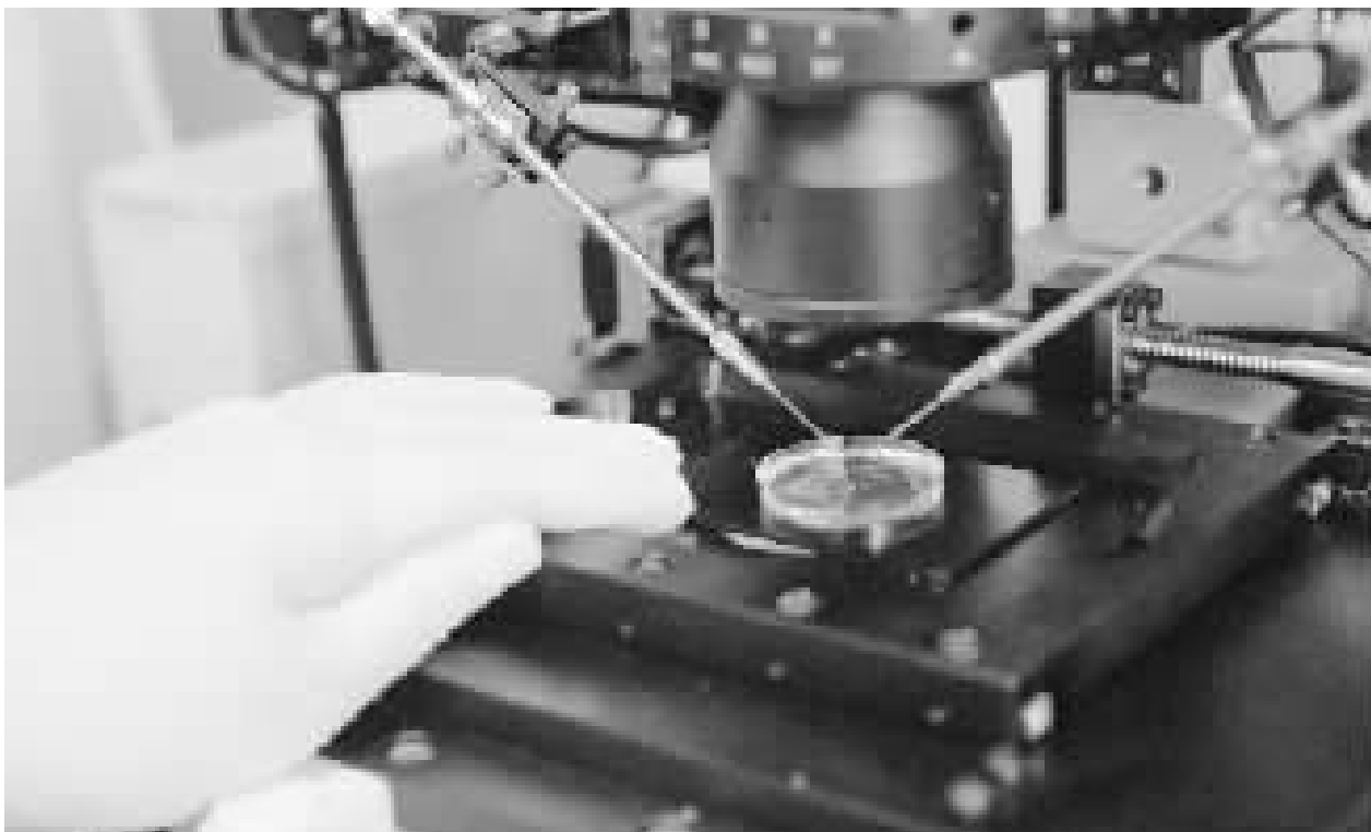
机器人正在操刀细胞核的抽取和注入，这是克隆猪的关键步骤。
