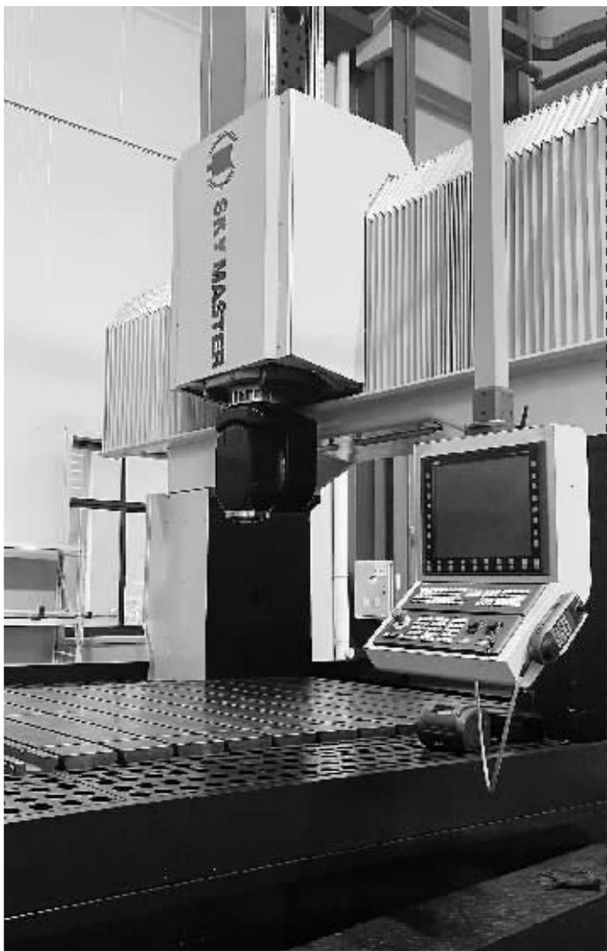
天瑞精工的五轴五联加工中心。
