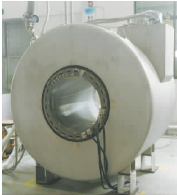
宁波健信核磁技术有限公司自主研发并量产的“1.5T无液氦超导磁体系统”。
