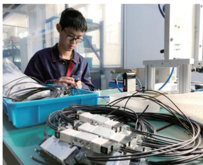
佳尔灵员工正在组装电磁阀
