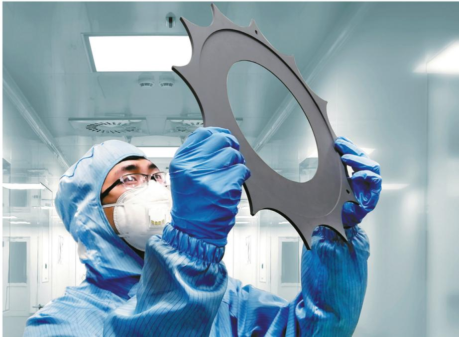
甬江实验室热场材料创新中心制备的高纯SiC涂层托盘已初步实现量产。（甬江实验室供图）
