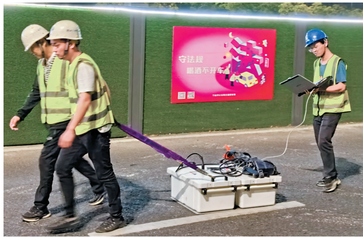
技术人员操作探地雷达进行探测。
