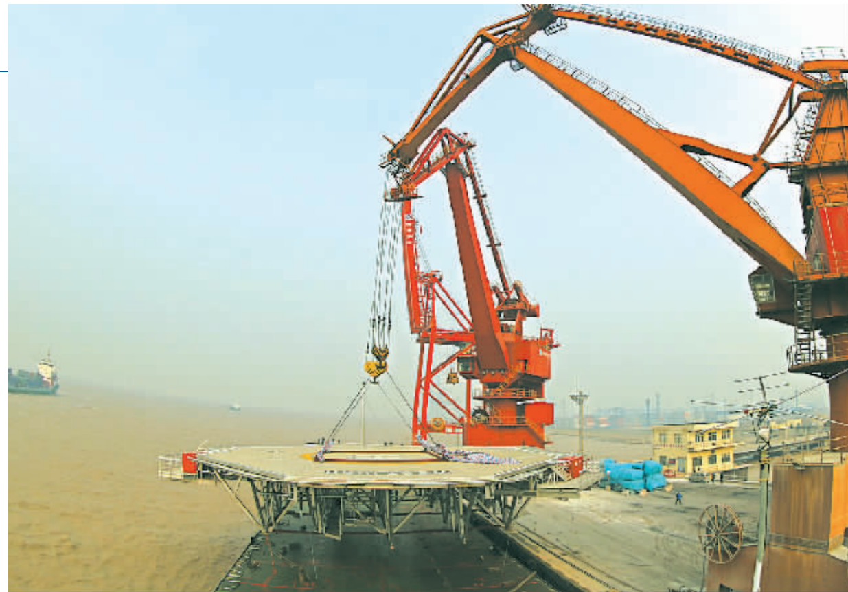
昨天，由宁波镇海区一家企业生产的直升机平台在大榭信业码头进行装载并运往韩国。据承运方宁波建航国际公司介绍，该平台长宽各34米、高6.9米。这是目前宁波港发运的尺寸最大的单件物品，首次实现在宁波整体的直升机平台制作及物流发运。
