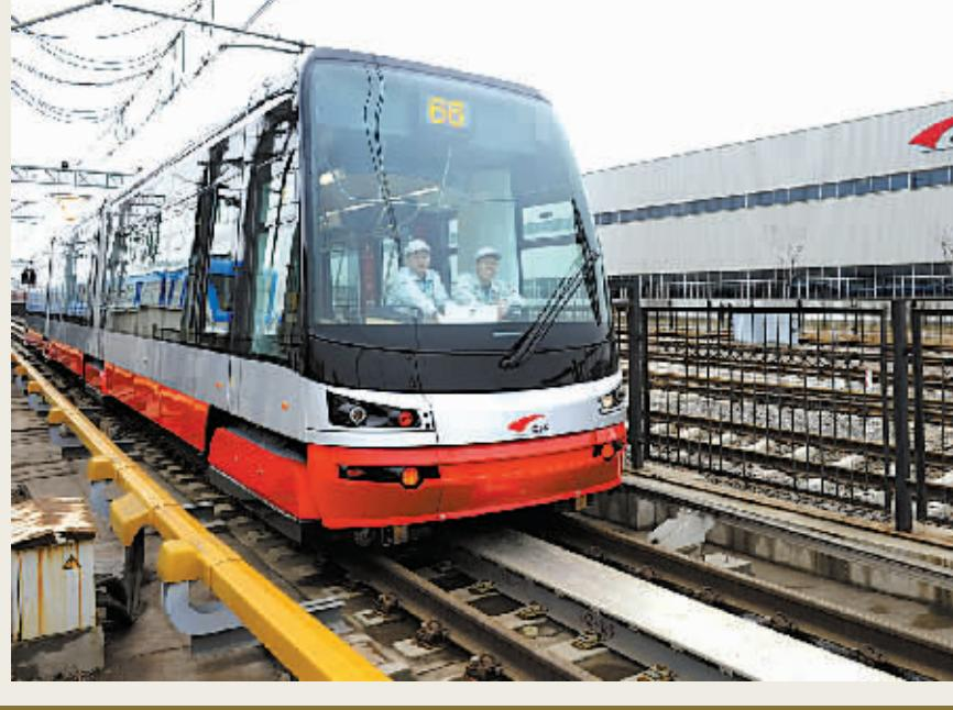
2月17日,新一代永磁有轨电车在测试线上运行。当日,国际目前最先进的第三代100%有轨电车样车在中国南车四方股份公司下线,该车辆在国内首次采用永磁电机驱动,较接触转向架两项世界领先技术,具有高效安全、低噪环保、运营维护成本低、曲线通过能力强的技术特性。该车辆的最高运行时速70公里,采用三节编组总载客量超过300人,车辆采用模块化设计、编组灵活,车内外全为低地板,车厢地板仅高出地面35厘米,方便乘客,尤其是老人、儿童及特殊乘客上下通行。据了解,随着我国城镇化进程的加快和构建低碳综合交通体系的要求,现代有轨电车有望成为城市公共交通发展的“新宠”。
