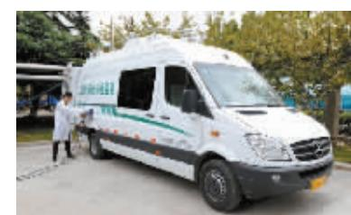
国内配备最先进的环境监测车。这台从奥地利进口的环境流动监测车具有五大优点：一是监测项目全。它能不间断地对几百种化合物进行实时在线流动检测。二是分析精度高。人对恶臭物质很敏感，往往人鼻子能闻到，而仪器测不出。而公司配置的在线质谱比人的鼻子还要灵敏。三是响应速度快。一般仪器分析需半小时以上，而公司配置的在线质谱测试一种物质只需0.1秒，响应速度快了1万多倍，能快速锁定污染源。四是稳定性好。一般仪器需要监测车停下来稳定半小时后才能监测，而公司配置的监测设备具有很强的抗震性，能做到边行驶边监测。
