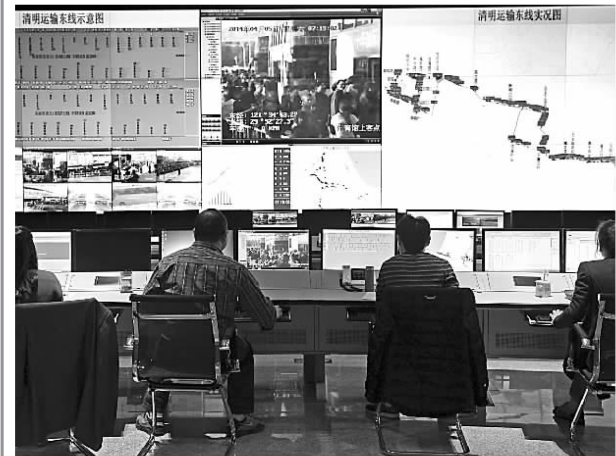
今年清明运输,市公交总公司启用了新的调度指挥中心,通过GPS移动指挥车、固定监控点和分别设立在体育馆、育王停车场、汶溪等主要疏运点的视频采集车,组成信息联络网,通过3G系统实时向指挥中心传输道路状况及客流信息,并通过GPS智能调度辅助指挥系统对专线车辆实施全程监控和调度。
