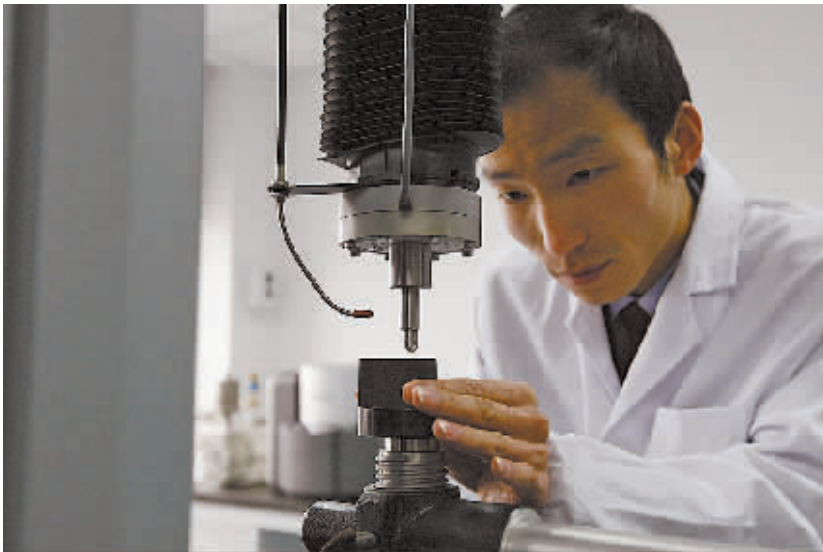
图为金属材料检测实验室技术人员采用硬度计进行金属材料硬度检测。（万勇 摄）
