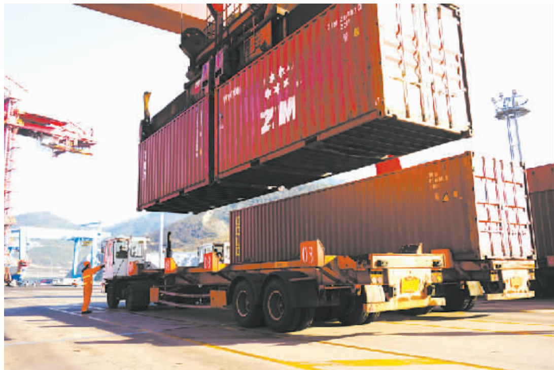
图为远东码头采用“桥吊双重循环”工艺作业时的场景。(伍晨卉 摄)
