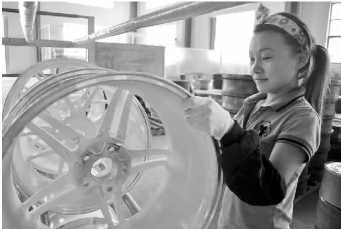
宝通轮业公司员工正在检测用熔汤锻造技术生产的汽车轮毂质量。(记者 谢挺 摄)
