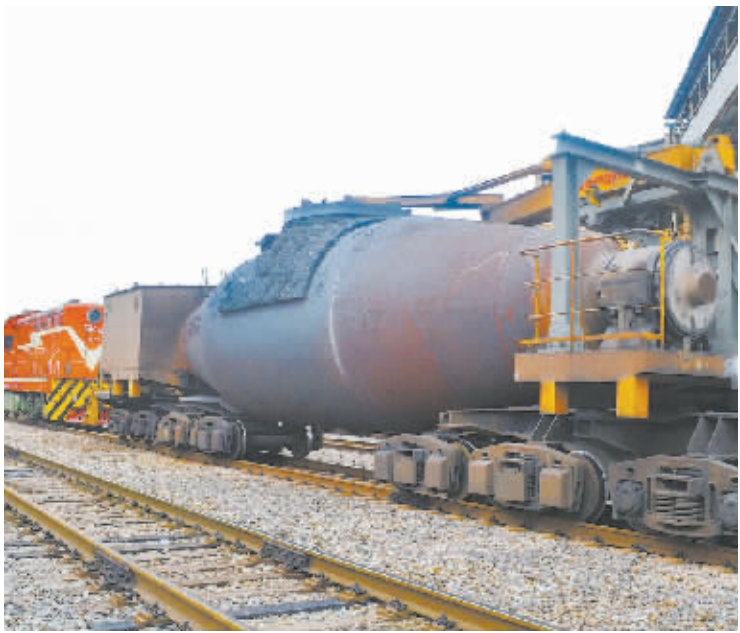
图为已加上盖的运输铁水的鱼雷罐。（记者 周亚琼 摄）
