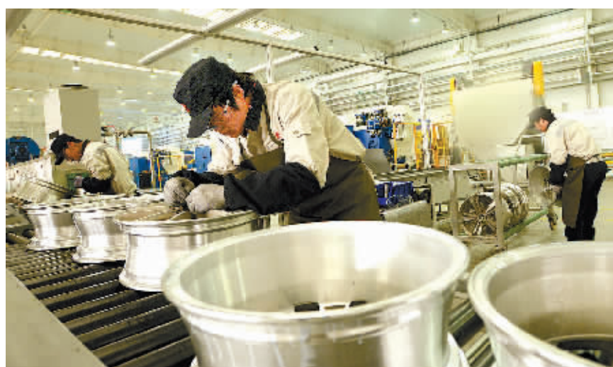
中信戴卡宁波轮毂制造有限公司总投资5.8亿元，产品主要提供给宝马、奥迪、丰田、克莱斯勒、本田等中高端汽车生产商。图为公司员工正在测量轮毂螺栓孔。(徐能 摄)
