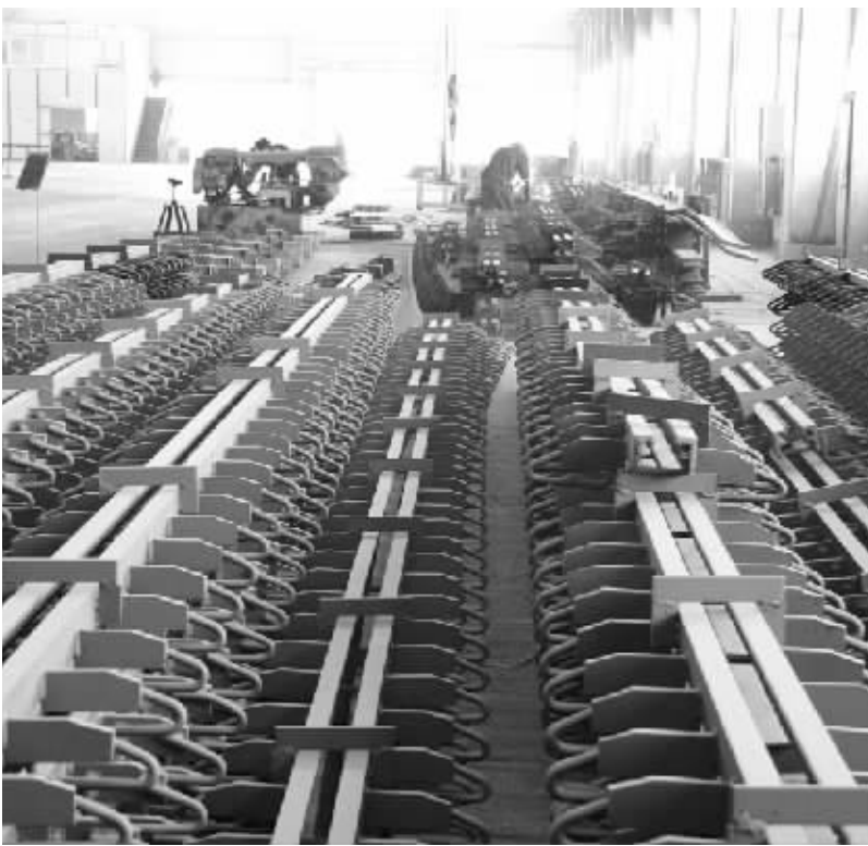
图为路宝集团的桥梁伸缩装置生产车间一角。(记者 张跃 摄)
