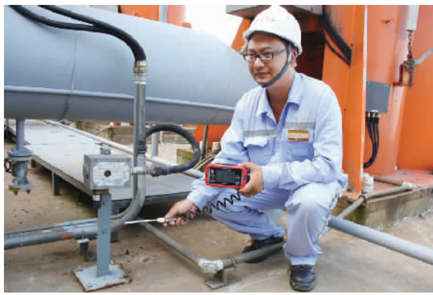
中油燃料油码头员工正在对比便携式检测仪与固定检测仪上的数据。(李平 薛新春 摄)
