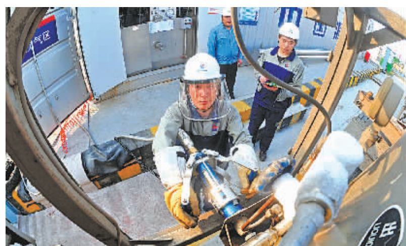
为集卡车加气。宁波港北仑港区集运公司加气站员工正在操作。（严龙 摄）
