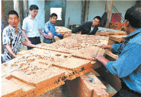
▲在一市镇东岙村,现年68岁的周衍柱老人正在修葺即将完工的戏台核心构件——藻井。从18岁开始,他一直从事这一行业。
