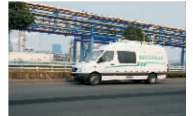
花园式工厂 国内首台投入使用的毫秒级在线质谱环境流动监测车走厂区实时环保巡查
