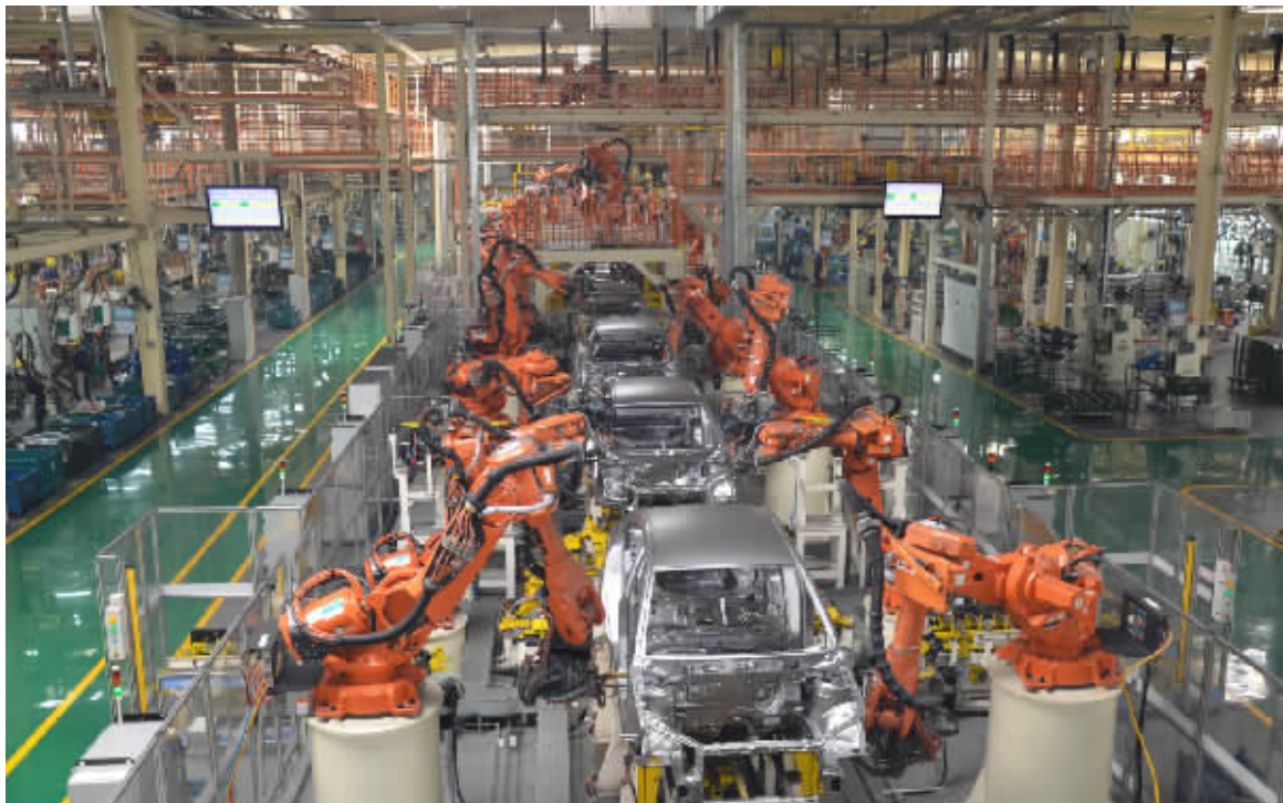
图为吉利汽车春晓基地自动化焊装生产线。
