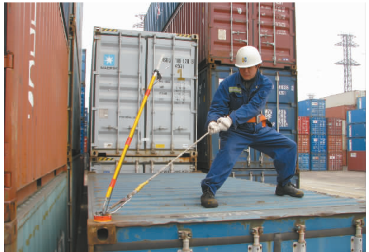
图为工人正在操作箱顶安全带挂钩器。
