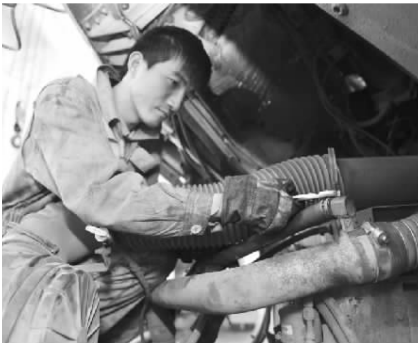
图为远东公司技术人员正在进行集卡液压混动装置改造。(记者 严雷 摄)
